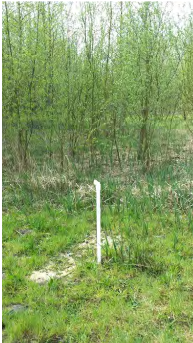
Foto: Monitoringsvoorziening kwetsbaar: peilbuis zonder mantelbuis.
